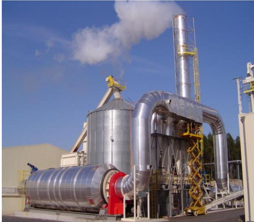
S.I.E. SWISS desarrolló para este caso una versión especial de su **deshidratador ALFA**, adaptado para utilizar la misma madera ó biomasa como fuente de calor. Además, es posible el aprovechamiento energético, como por ejemplo: gases calientes de una cogeneración, entre otros.
